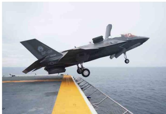
**L'**F-35 Lightning II è un velivolo caccia multiruolo di quinta generazione con spiccate caratteristiche stealth (bassa osservabilità da parte dei sistemi radar) e net-centriche (interconnessione di tutti i sistemi di comunicazione, informazione e scambio dati a disposizione); il velivolo sarà prodotto in tre versioni: **F-35A** a decollo convenzionale; **F-35B** a decollo corto e atterraggio verticale (STOVL) per portaerei con ponte adatto; **F-35C** per portaerei con catapulte (CATOBAR);
