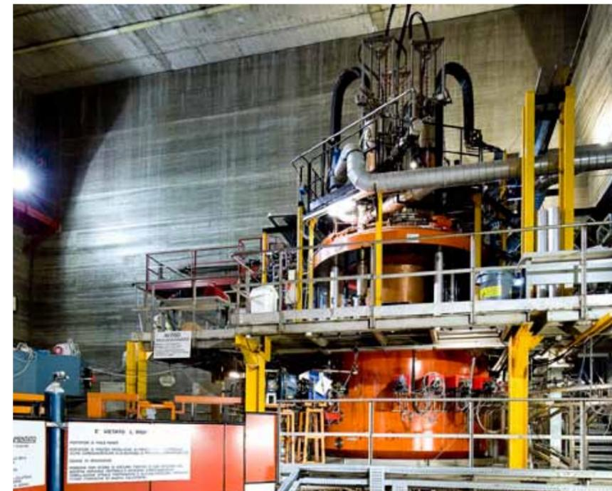
Il **Ciclotrone SuperConduttore (CS)** nei LNS, è una macchina forte e compatta tri-settoriale. Il polo radio è 90 cm. e il range del campo magnetico al centro è tra 2.2 e 4.8 T. La macchina acceleratrice fu inventata da Lawrence negli anni '30, il cui principio di funzionamento si basa sulle caratteristiche della forza di Lorentz. Gli svantaggi di questa macchina risiedono nella complessità del sistema criogenico e nello spazio a disposizione per i sistemi di diagnostica del fascio.
